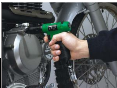
Atornillador tipo pistola equilibrada
